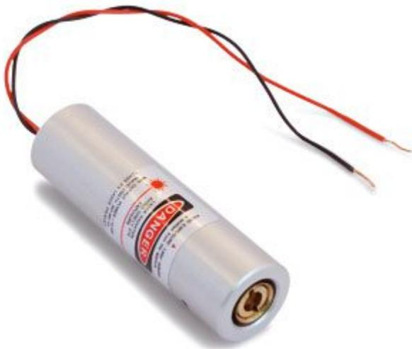
Modulo laser con emissione UV (405 nm) conforme alle norme EN60825-1, adatto per applicazioni scientifiche di fluorescenza e di polimerizzazioni di collanti. Il modulo collaudato per 200 ore in emissione continua e sottoposto a 300 cicli di ON/OFF, viene fornito con certificato di collaudo. Il dispositivo richiede una tensione di alimentazione di 3 volt e una corrente <200 mA fornita da un alimentatore che deve essere necessariamente di tipo lineare.
