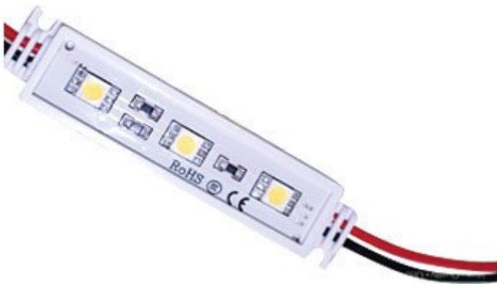
Modulo LED con alimentazione 12V, potenza: 1 watt, flusso luminoso: 36 Lumen, colore: bianco caldo, grado di protezione: IP68, vita media: 50.000 ore. Dimensioni: 75 x 17 x 5 mm.
