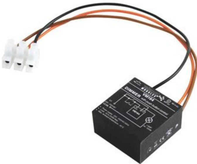
Mini dimmer controllato da microcontrollore. Permette di controllare lampade ad incandescenza, lampade alogene e le nuove lampade alogene a risparmio energetico. Il dispositivo va collegato nel circuito di illuminazione esistente, è sufficiente aggiungere uno o più pulsanti. Dispone di funzione soft-start per prolungare la durata di vita delle lampade. Completo di circuito per la soppressione di interferenze Radio e TV.
