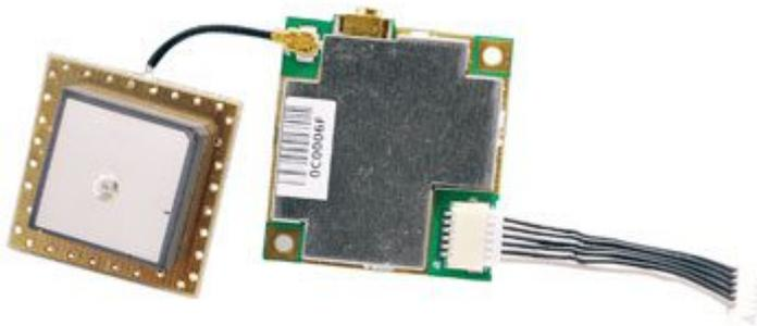
Modulo GPS con chipset SiRF Start III a 20 canali. È caratterizzato da dimensioni particolarmente ridotte (misura appena 30 x 28 x 4,6 mm) e da una sensibilità elevata (-159 dBm). Estremamente veloce TTF (Time To First Fix) anche con bassi livelli di segnale. Supporto NMEA 0183 e protocollo binario SiRF.
