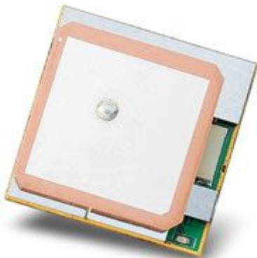
Basato sul chipset SiRF Start III a 20 canali, è caratterizzato da una sensibilità di -159 dB e da dimensioni particolarmente ridotte (30 x 30 x 10,5 mm). Particolarmente adatto per applicazioni che richiedono pochissimo ingombro.
