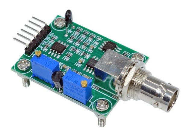
Modulo per la rilevazione del livello di pH e della temperatura in una soluzione acquosa. Consente di realizzare un pHmetro a basso costo estremamente preciso e affidabile. Integra il sensore di temperatura LM35, dispone di connettore BNC e interfaccia pH2.0. Per utilizzare questo modulo è sufficiente collegare una sonda pH al connettore BNC e l'interfaccia pH2.0 alla porta di ingresso analogico di una board che può essere Arduino o Fishino.
