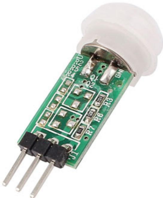
Sensore PIR in miniatura con scheda di controllo e con uscita da interfacciare ad un microcontrollore, Arduino, ecc (livello alto 3,3V - basso 0V). Tempo di ritardo 10 secondi (non impostabile), consumo a riposo inferiore a 50  $\mu$ A, angolo di rilevamento di 110°, portata massima 5 metri. Dispone solamente di tre piedini (uscita, positivo e negativo di alimentazione).
