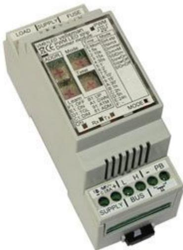
Modulo Velbus dimmer per lampade LED o strisce di LED a 12 o 24 Vdc. Può essere utilizzato stand-alone o con sistema Velbus (247 indirizzi). Dispone di protezione termica e da cortocircuito. Alimentazione: da 10 a 30 Vdc, massima corrente di uscita: 5 A. Contenitore compatibile con guide DIN Standard (2 moduli).
