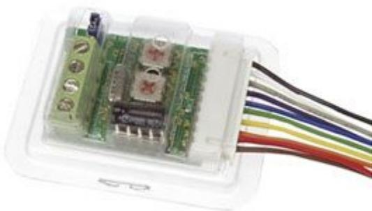
Studiato appositamente per collegare, ai moduli per automazione industriale e domotica funzionanti con il sistema CAN-BUS (VELBUS), fino ad un massimo di 8 pulsanti. Tensione di alimentazione 12 Vdc. Per scaricare il manuale "Velbus Timer Application" clicca [qui](#).
