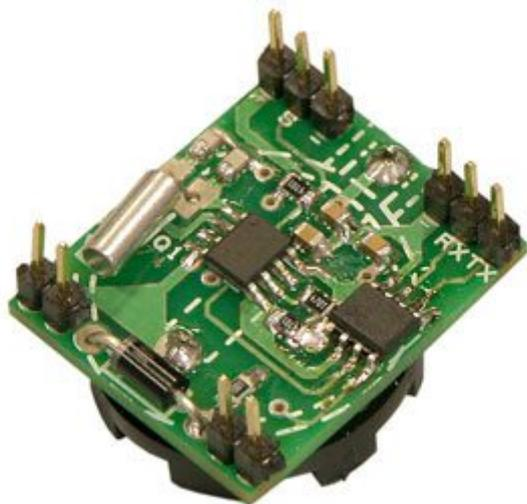
Con un ingombro di pochi centimetri quadri e un consumo di corrente irrisorio, genera data e ora di sistema. Facilmente implementabile in qualsiasi apparato digitale, comunica con l'esterno tramite una porta seriale e dispone anche di un segnale di clock programmabile. Grazie ad un sistema di back-up interno, può mantenere i dati in memoria anche in assenza di corrente. Alimentazione: 5 Vdc - Assorbimento: 1,5 mA - Dimensioni: 27 x 23 mm. **La batteria a bottone non è inclusa.**
