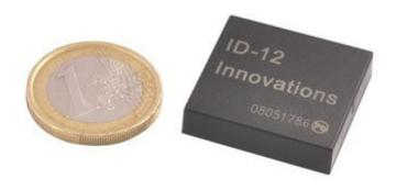
Il modulo ID12LA è un lettore RFID tra i più piccoli e compatti attualmente disponibili sul mercato (26 x 25 x 7 mm). Dispone di antenna interna. Possibilità di collegare un LED e un buzzer come segnalatori di lettura. Formato dati d'uscita seriale ASCII, Wiegand26 e Magnetic ABA Track2. Il funzionamento è estremamente semplice, basta alimentare il modulo e avvicinare la tessera RFID per avere in uscita una stringa contenente il codice ID della tessera.
