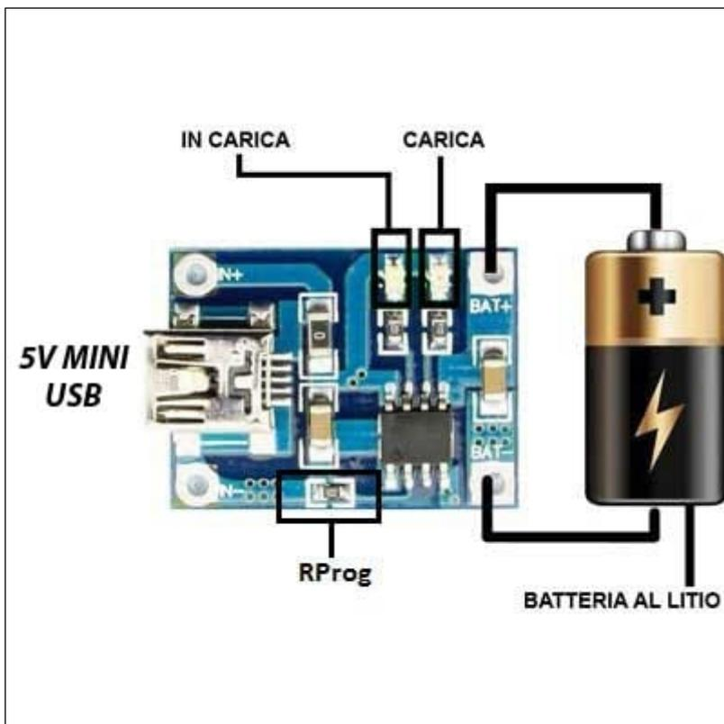
Piccolo modulo per la ricarica di batterie agli ioni di litio a singola cella. Metodo di carica: lineare, corrente di carica: 1 A (aggiungendo esternamente una resistenza), alimentazione: 5 V (tramite mini USB), 2 LED che indicano lo stato di carica (LED rosso acceso: in carica - LED blu acceso: carica completata), tensione di carica fissata a 4,2 V, dimensioni (mm): peso: 3 grammi. Di default il modulo è configurato per fornire 1 A di corrente.
