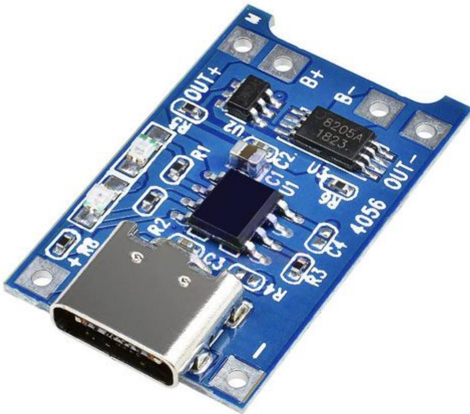
Basato sui chip TP4056A, DW01A e sul doppio MOSFET a canale N FS8205A, questo piccolo modulo è ideale per la ricarica di batterie agli ioni di litio a singola cella.
