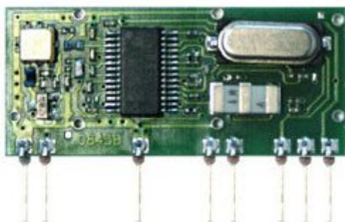
Ricevitore supereterodina FM ad elevata sensibilità e selettività, munito di filtro SAW front-end che lo rende altamente immune ai disturbi. Grazie al pin di enable il ricevitore può assumere lo stato di power-down in assenza di segnale e minimizzare così il consumo a 0,5 mA. Ideale per codifica Keeloq di Microchip.
