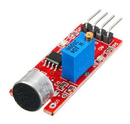
Modulo dotato di microfono in grado di rilevare l'intensità sonora dell'ambiente circostante. Dispone di trimmer per la regolazione della sensibilità microfonica, LED di stato per alimentazione e rilevamento suono, uscita analogica e uscita digitale. Alimentazione: 5 VDC, dimensioni (mm): 35x15x15, peso: 3 grammi. **N.B.** Questo modulo non è un riconoscitore di voce.
