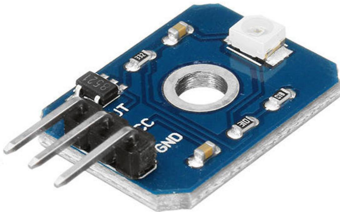
Piccolo modulo dotato di sensore in grado di misurare l'indice UV della luce solare, di lampade o altre fonti, che hanno una lunghezza d'onda compresa tra 200 nm e 370 nm. Fornisce in uscita una tensione lineare proporzionale all'intensità degli UV. Alimentazione: da 3,3 a 5 VDC, dimensioni (mm): 20x15,5x5. Indicato per tester di ultravioletti, rilevatori di ultravioletti per uso esterno, rilevatori di ultravioletti per lampade germicide.
