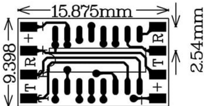
Questo piccolo modulo, basato sul chip MAX3232CSE, converte in modo bidirezionale i livelli di tensione RS232 e TTL. Alimentazione: da 3 Vdc a 5 Vdc, Baud Rate: max. 120kbps, dimensioni (mm): 16x9.
