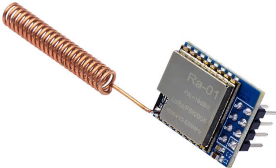
Compatto modulo ricetrasmittitore RF a 433 MHz basato sul chip SX1278 della Semtech Corporation. È dotato di antenna a molla, I/O digitale (DIO0), una elevata sensibilità (-141dBm) in modulazione LoRa™ e una elevata potenza d'uscita (+18dBm). È particolarmente indicato per essere utilizzato in telecomandi, contatori intelligenti, Home Automation, logger personali, rete di sensori wireless, periferiche wireless per PC, ecc.
