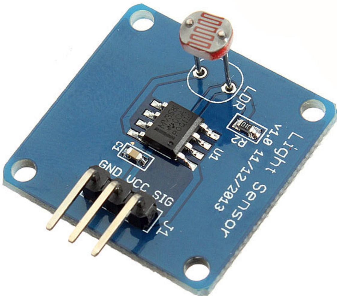
Questo modulo impiega una fotoresistenza e un amplificatore operazionale per rilevare le variazioni di luminosità ambiente. Il modulo dispone di 3 pin per alimentazione (GND e VCC) e segnale di uscita (SIG). La tensione tra i pin GND e SIG varia al variare della luce ambiente. Quando è completamente buio avremo circa 0 volt, mentre alla massima luminosità avremo 5 volt. Può essere utilizzato per realizzare interruttori crepuscolari tramite Arduino/Fishino o schede a relè.
