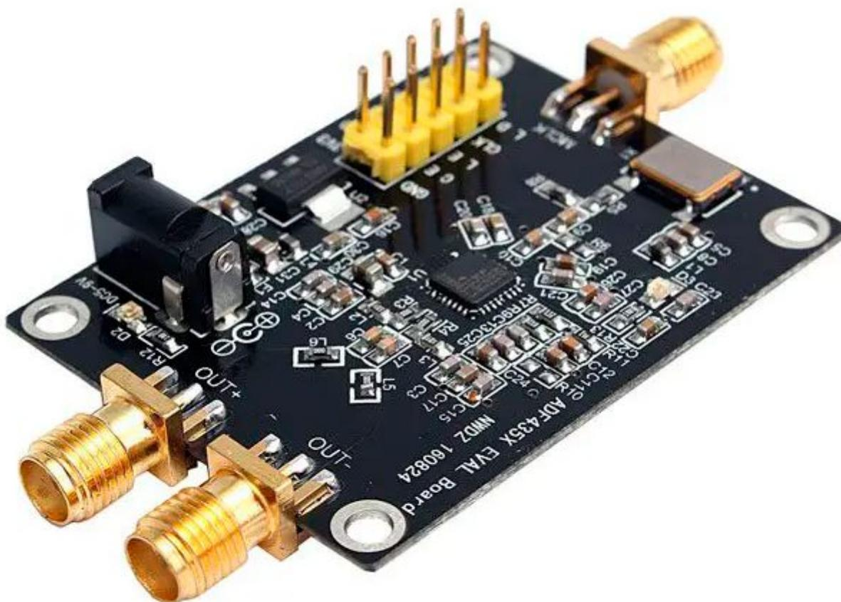
Modulo basato sul circuito integrato ADF4351 dell'Analog Devices, un sintetizzatore di frequenza a larga banda costituito da un oscillatore a cristallo da 25 MHz, un filtro di loop, un regolatore LDO, il filtro di loop, l'oscillatore attivo a cristallo da 25 MHz utilizzato come sorgente di riferimento, rendono disponibile il segnale RF su due uscite complementari, ed un terzo siglato REF IN, per la connessione di una sorgente di riferimento.
