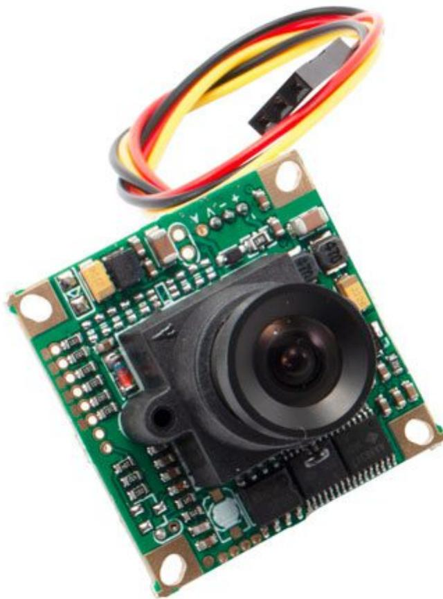
Modulo telecamera a colori con sensore da 1/3" CCD con DSP SONY. Dotata di ottica f3.6 mm, altissima risoluzione a 700 linee TV e sensibilità 0,1 Lux. Il DSP SONY permette di ottenere immagini ad alta risoluzione, alto rapporto S/N (riduzione del disturbo ottenuta attraverso speciali filtri) ed alta fedeltà dei colori.
