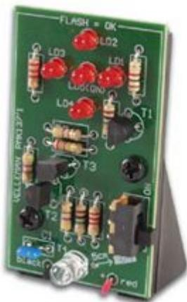
Modulo che consente di testare in maniera estremamente semplice il corretto funzionamento del telecomando a infrarossi. Quest'ultimo va puntato in direzione del tester premendo di seguito un qualsiasi tasto. In caso di esito positivo i 4 led rossi incominceranno a lampeggiare.
