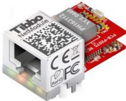
Modulo TIBBO composto dal modulo EM1206 e da connettore RJ45 10/100BaseT completo di filtri magnetici (codice RJ203).
