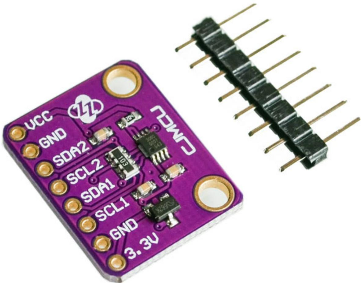
Doppio traduttore di livelli logici I2C basato sul chip PCA9306 della Texas Instruments. Consente di gestire livelli logici da 1,2 a 3,3 volt e da 1,8V a 5,5V. Funzionamento bidirezionale con controllo automatico della direzione. Alimentazione: da 1,2 a 5,5 volt, temperatura di lavoro: da -40°C a +85°C, dimensioni (mm): 21x17x2,5. Applicazioni: I2C, SMBus, PMBus, MDIO, UART, SDIO a bassa velocità, GPIO, automazione industriale, ecc.
