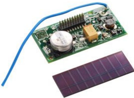
Modulo con consumi estremamente ridotti è adatto ad essere affiancato a dei sensori. L'alimentazione può essere esterna oppure generata da una piccola cella solare (13 x 28 mm) fornita insieme al modulo. L'antenna è preinstallata (spezzone di filo 9 cm). Frequenza di trasmissione: 868.3 MHz, potenza: max. 10 mW. Dimensioni del modulo: 21 x 40 x 9 mm - range di temperatura: -25°C a +65°C.
