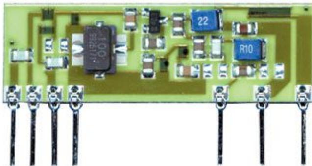
Trasmettitore SAW con antenna esterna ideale in applicazioni dove si voglia modulare on-off una portante R.F. con dati digitali. Caratterizzato da alta efficienza e bassa emissione di armoniche. Caratteristiche principali: realizzazione in circuito ibrido su allumina ad alta affidabilità
