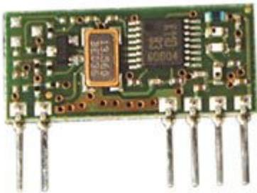
Modulo trasmettitore RF a 433 MHz con modulazione FSK ed antenna esterna per applicazioni LPD. Il modulo dispone di PIN di Enable che permette di farlo funzionare in modalità di basso consumo ( $< 1 \mu\text{A}$ ).
