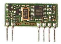
Modulo trasmettitore RF a 433 MHz con modulazione FSK ed antenna esterna per applicazioni LPD. Piedinatura compatibile con i moduli FSK TX-SAW-MID. Realizzato in ottemperanza alle Normative Europee EN 300-220 ed EN 301-489.
