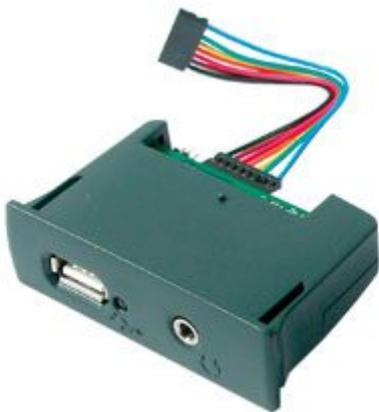
Il modulo VMUSIC2, oltre ad interfacciare una pen drive USB ad un microcontrollore, permette di riprodurre file MP3 e altri formati di musica digitale direttamente da una pen drive USB. Il set di comandi del firmware VDIF permette di riprodurre il file selezionato così come il controllo del volume, bilanciamento, etc.
