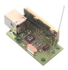
Il modulo USB RF04 è un ricetrasmettitore in grado di comunicare via radio con dispositivi wireless come: 7300-CM02/400 e 7300-ER400TRS. Il circuito preleva l'alimentazione direttamente dalla porta USB del PC e comunica con questo tramite una porta seriale virtuale che viene creata quando viene connesso alla porta USB. Particolarmente indicato per essere utilizzato in abbinamento al modulo CM02/400. Dimensione: 44 x 24 mm.
