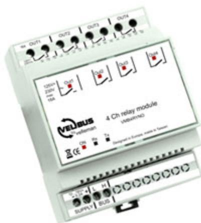
Modulo per automazione industriale e domotica con quattro relè di uscita. Utilizza un protocollo CAN-BUS, denominato VELBUS. I relè d'uscita possono essere utilizzati per controllare qualsiasi carico elettrico. Dispone di 10 differenti modalità di funzionamento: monostabile, on / off, start/stop timer, controllo luci scala, timer non retriggerabile, spegnimento ritardato, accensione ritardata, avvio timer su rilascio pulsante, lampeggiatore temporizzato, doppio timer.
