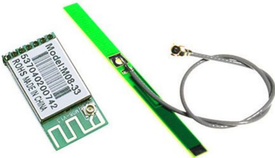
Set composto da un modulino Wi-Fi USB 2.0 per Arietta-G25, antenna su PCB con cavetto lungo 11 cm e connettore UMC da 2 mm. Il modulino Wi-Fi standard IEEE 802.11 b/g/n è basato sul chip RaLink RT5370N, si alimenta a 3,3 Volt e può essere configurato anche in modalità Access Point.
