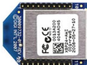
Modulo XBee Pro della Digi (Maxstream) con frequenza a 2.4 GHz, potenza 60 mW e antenna a filo. Basato sullo standard 802.15.4 (la base di [Zigbee](#)), consente di creare una rete wireless tra microcontrollori, computer e altri dispositivi dotati di porta seriale. La serie Pro ha la stessa piedinatura e set di comandi della serie base. Questo prodotto è stato utilizzato nel progetto "UAV BIMOTORE" pubblicato sulla rivista ELETTRONICA IN n°157 GIUGNO 2011.
