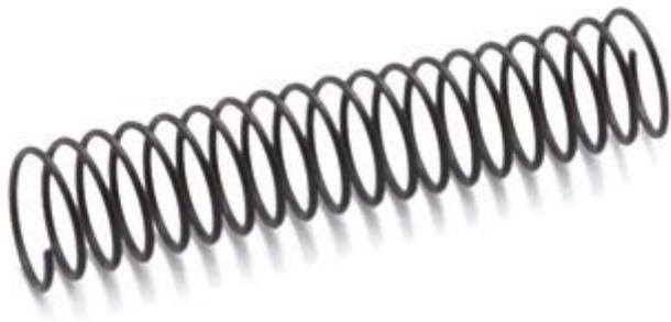
Molla realizzata con filo metallico di Flexinol del diametro di 0,35 mm. La molla può essere estesa fino a 27 cm a temperatura ambiente. Quando viene riscaldata (basta il semplice calore della mano) si contrae fino a una lunghezza di 27 mm. Diametro esterno della molla: 5,5 mm; Lunghezza: circa 27 mm; diametro filo della molla: 0,35 mm.
