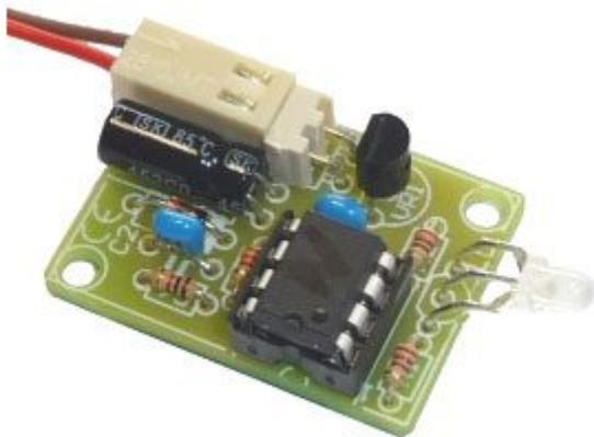
Compatto dispositivo (30 mm x 20 mm) che permette di controllare, tramite un LED bicolore da 3 mm, lo stato di carica della batteria. Utilizza solo due fili per il collegamento. Alimentazione: 12 Vdc. N.B. disponibile anche montato codice VM189.
