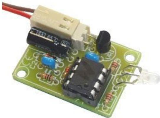
Compatto dispositivo (30 mm x 20 mm) che permette di controllare, tramite un LED bicolore da 3 mm, lo stato di carica della batteria. Utilizza solo due fili per il collegamento. Alimentazione: 12 Vdc. N.B. disponibile anche in kit codice MK189.
