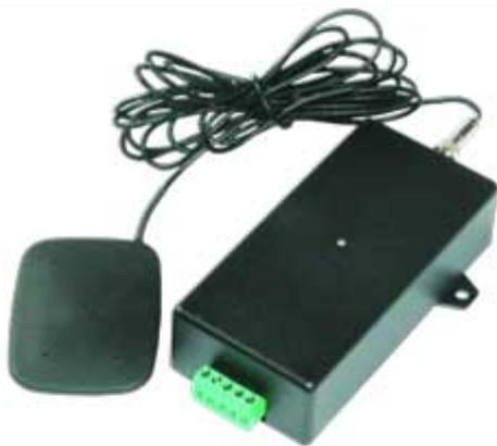
**Sistema GSM in grado di attivare un relè di uscita quando viene chiamato da un telefono fisso o mobile precedentemente abilitato. La gestione dei numeri autorizzati è realizzata mediante l'invio di SMS convalidati da password. Accede ai servizi GSM utilizzando un modulo Sony Ericsson GM47. Ideale per realizzare controlli di accesso remoti.**
