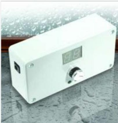
Utilizza due sensori per rilevare le condizioni atmosferiche (vento e pioggia) ed un microcontrollore per la gestione dei dati rilevati con la possibilità di attivare un'uscita a relè nel caso venga superata la soglia di allarme preimpostata. Ideale per controllare tende da sole e persiane motorizzate che in questo modo si chiudono automaticamente in caso di vento forte o pioggia.
