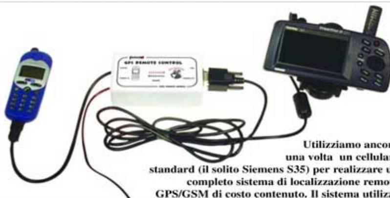
Utilizziamo ancora una volta un cellulare standard (il solito Siemens S35) per realizzare un completo sistema di localizzazione remoto GPS/GSM di costo contenuto. Il sistema utilizza la nuova cartografia vettoriale Fugawi.
