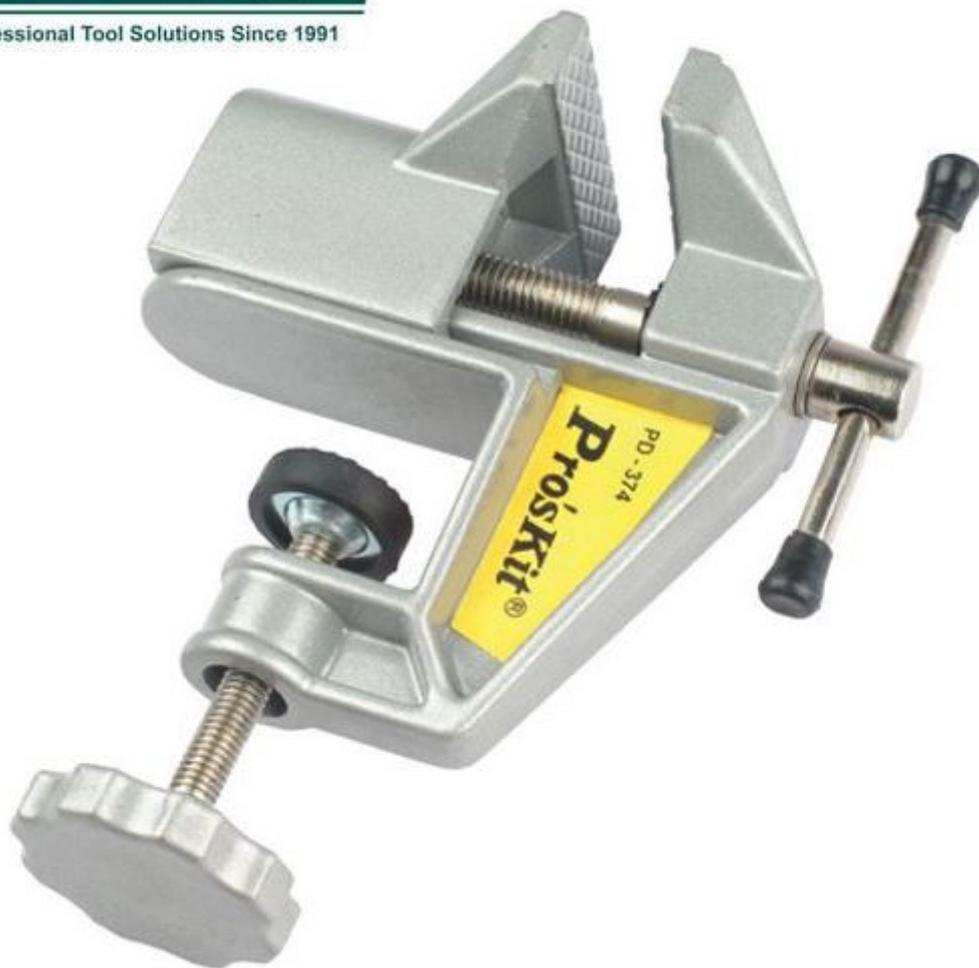
Questa morsa da banco in alluminio è l'accessorio ideale per chiunque lavori con schede e apparecchiature elettroniche. Grazie al suo corpo robusto e alla sua apertura fino a 40 mm, consente di fissare saldamente i componenti durante le operazioni di lavorazione. Inoltre, il fissaggio al piano è regolabile e può essere fissato su piani con uno spessore massimo di 28 mm. Le sue dimensioni di 120 x 150 x 60 mm e il peso di 450 grammi lo rendono facile da maneggiare e
