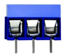
Morsettiera componibile con serraggio a vite, montaggio da circuito stampato, 3 poli passo 5 mm.
