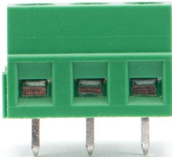
Morsettieria componibile con serraggio a vite, montaggio da circuito stampato, 3 poli passo 5 mm.
