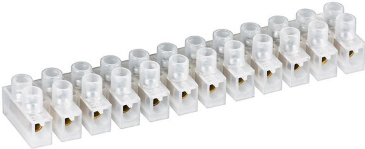
Morsetto isolante trasparente a 12 vie con serraggio a vite. Indicato per la connessione di cavi con sezione max. 4 mm<sup>2</sup> e una corrente max. di 3 A. Confezione da 10 pezzi.
