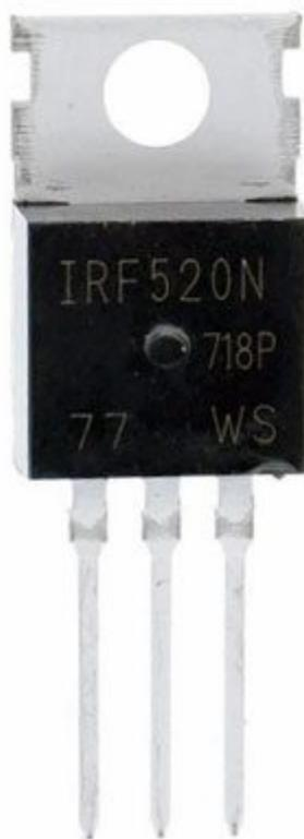
MOSFET di potenza a canale N. Corrente massima di drain 9,7 A, tensione massima drain source 100 V, tensione di soglia gate massima 4 V, tensione di soglia gate minima 2 V, tensione massima gate source  $\pm 20$  V, tipo di package TO-220, numero pin 3, dissipazione di potenza massima 48 watt.
