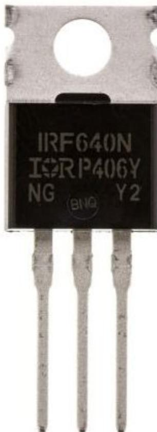
MOSFET di potenza a canale N. Corrente massima di drain 18 A, tensione massima drain source 200 V, resistenza massima drain source 150 Mohm, tensione di soglia gate massima 4 V, tensione di soglia gate minima 2 V, tensione massima gate source  $\pm 20$  V, tipo di package TO-220AB, numero pin 3, dissipazione di potenza massima 150 watt.
