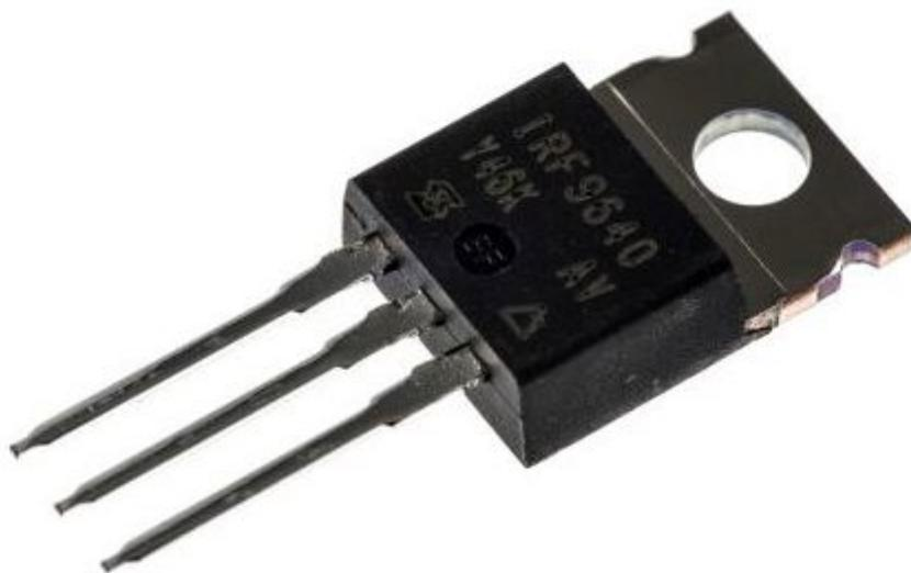
MOSFET di potenza a canale P. Corrente massima di drain 11 A, tensione massima drain source 200 V, resistenza massima drain source 500 Mohm, tensione di soglia gate minima 2 V, tensione massima gate source  $\pm 20$  V, tipo di package TO-220AB, numero pin 3, dissipazione di potenza massima 125 watt.
