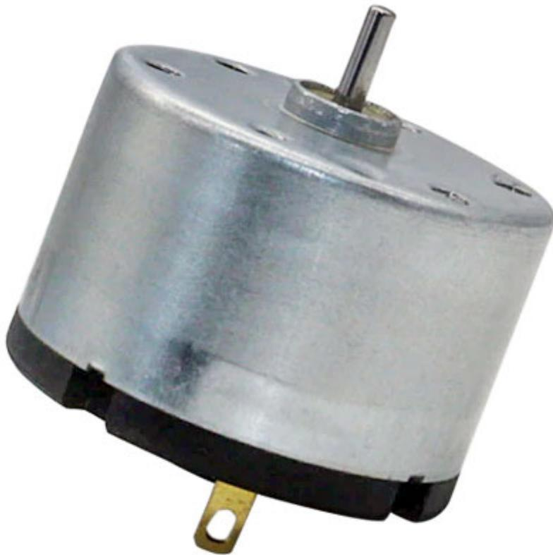
Motore con alimentazione compresa tra 6 e 12 VDC. Velocità a 6 VDC: 3.000 rpm, velocità a 12 VDC: 6.000 rpm. Dimen
