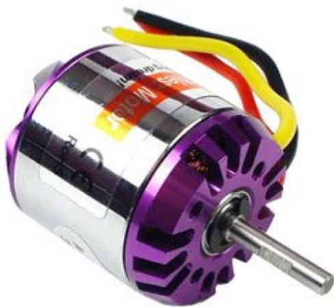
Motore brushless a cassa rotante. RPM / V (Kv): 3500 - batteria: 2-3 Lipo - ESC: 40 A - dimensioni albero motore:  $\varnothing$  3,17 mm x 51 mm - dimensioni motore:  $\varnothing$  28 mm x 36 mm - peso: 60 g. Ideale per modellismo e robotica.
