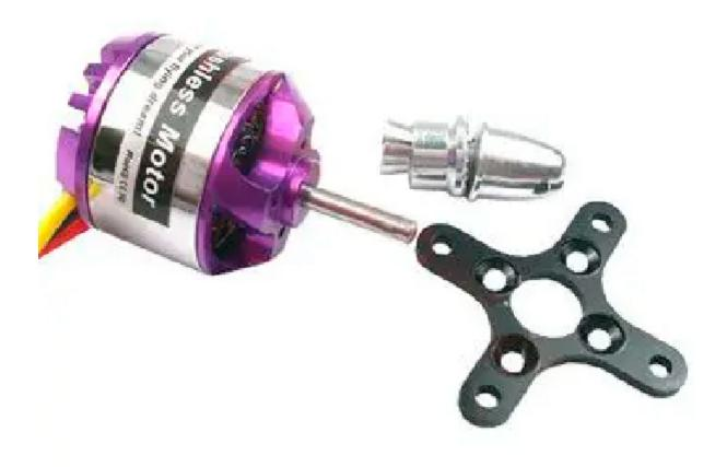
Motore brushless a cassa rotante. Alimentazione: da 7,4 a 14 V, KV (rpm/V): 850, massima potenza: 187 watt. Batteria: 2-4 Lipo, ESC (electronic speed controllers): 30 A, dimensioni albero motore:  $\emptyset$  3,17 mm × 45 mm, dimensioni motore:  $\emptyset$  28 mm × 30 mm, peso: 52 g. Ideale per modellismo e robotica.
