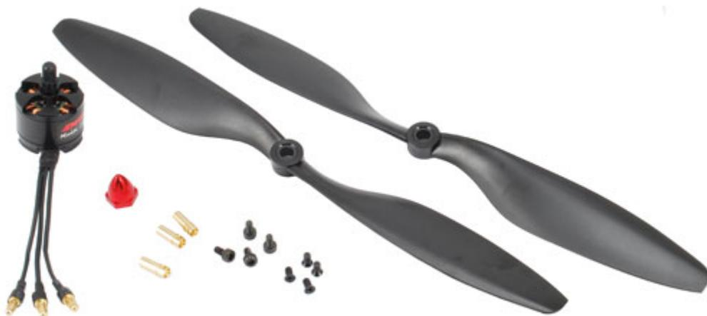
Motore brushless a cassa rotante con filettatura CW per multirotori completo di due eliche 10x4,5 (1 destra e 1 sinistra). Alimentazione: 11,1 V (3S) - 14,8 (4S), velocità: 935 Kv, spinta massima: 850 grammi, ESC consigliato: 18 A, eliche consigliate: 10x4,5 (comprese) / 8x4,5 (non comprese). Dimensioni motore (mm): Ø 27,9 x 25,7 lunghezza, albero motore (mm): Ø 6 x 39,7 lunghezza, peso: 55 grammi. Ideale per modellismo e robotica.
